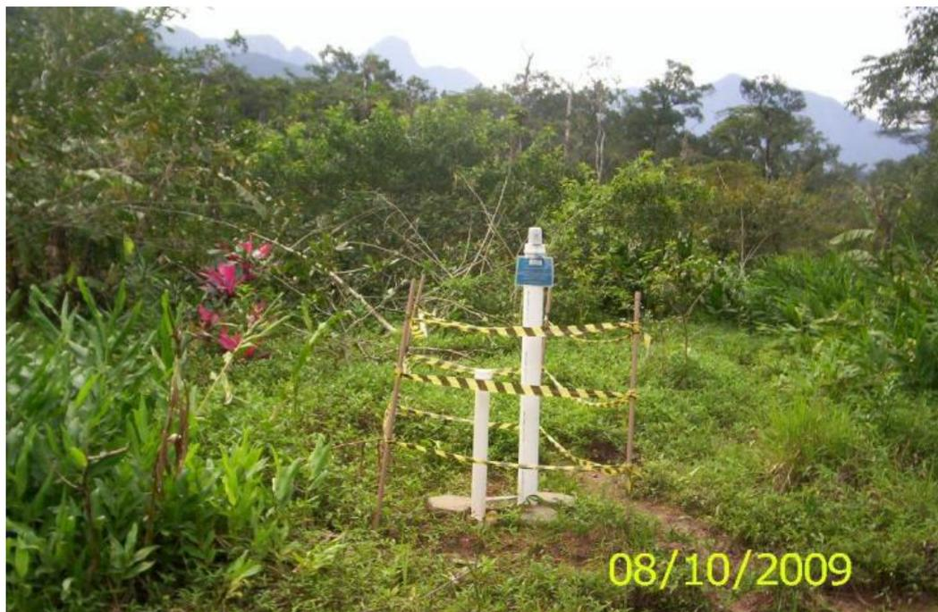
Figura 9: Pluviômetro em atividade no perfil Morada da Praia (Pluv-6). O sensor ambiental está sobre o tubo maior, à direita, e o receptor digital encontra-se no interior do tubo menor. Notar a placa identificadora em azul.
