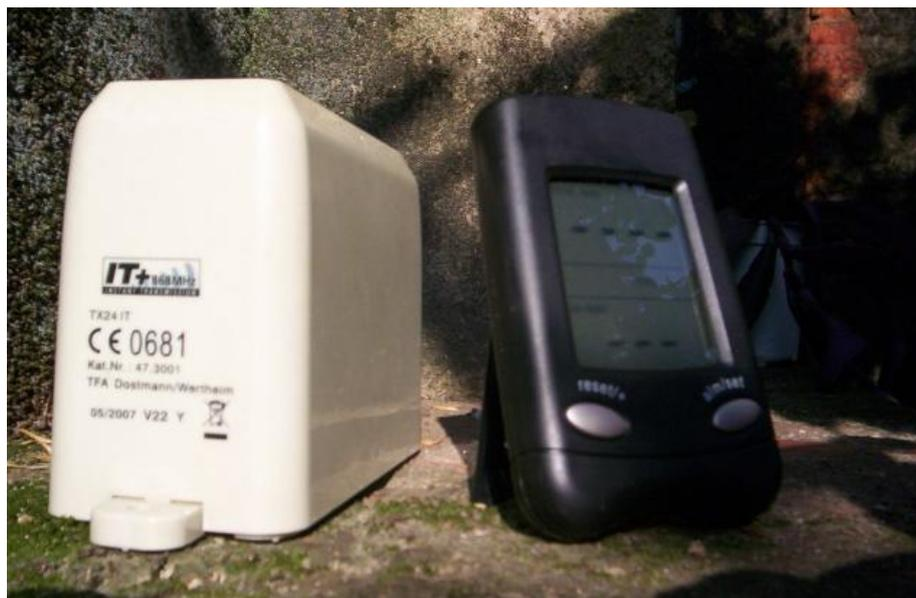
Figura 8: Sensor ambiental com transmissão remota de medições de chuva por sinal 868 Mhz; à esquerda, receptor digital sem fio.
