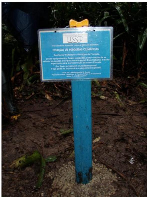
Figura 17: Poço de monitoramento piezométrico selado com pellets de bentonita (usados para impermeabilizar a superfície do terreno), e identificado com placa plastificada.
