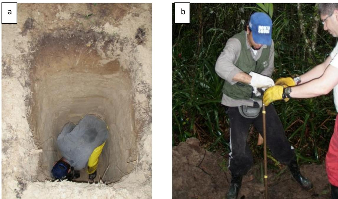
Figura 15: (a) Processo de escavação de uma trincheira em depósito arenoso.( b) Perfuração de poço de monitoramento com trado manual.
