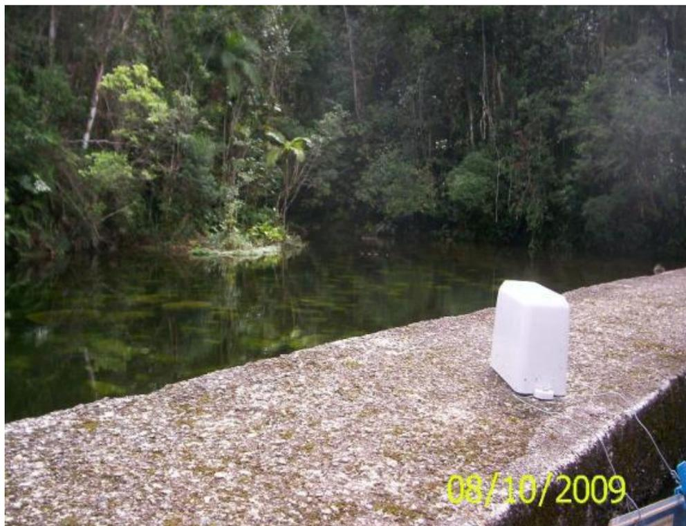
Figura 10: (esquerda). Sensor ambiental fixado sobre o muro da barragem de captação de água do Condomínio Morada da Praia (Pluv-7).
