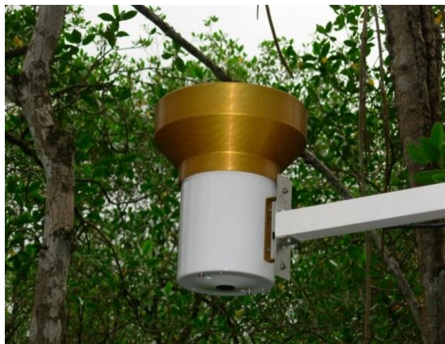
Figura 19 - Pluviômetro instalado nos manguezais da Barra do Ribeira, tipo TE525MM-L15. Foto: Nádia G. B. de Lima (2008).
