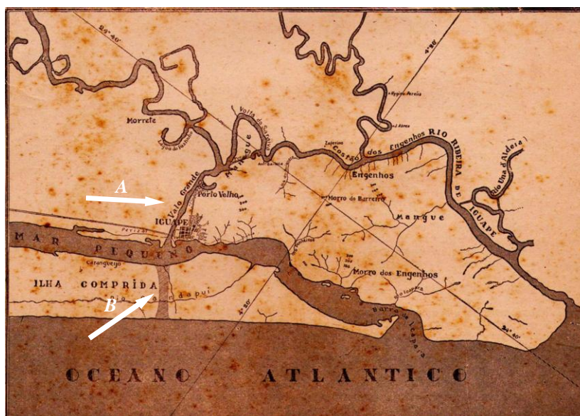
Figura 5 - Projeto original do Valo Grande (seta A) e seu prolongamento (seta B) até a Ilha Comprida, que não foi executado. Fonte: DAEE (2011).
