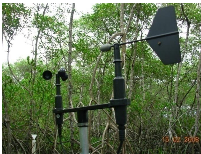
Figura 20 - Sensor de velocidade e direção do vento, instalados no manguezal da Ilha dos Papagaios, Barra do Ribeira – Iguape/SP, no nível 2 m. Foto: Nádia G. B. de Lima (2008).
