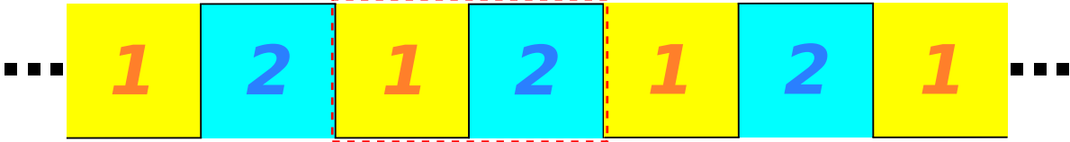
Figura 4.2 – Exemplo de uma superrede montada a partir da heteroestrutura mostrada na figura 4.1. A região destacada em vermelho define uma supercélula unitária
