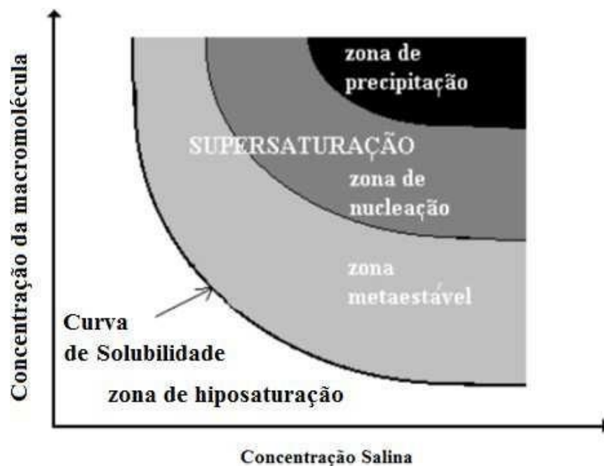
Figura 12 - Diagrama de fases da solução de proteína em função da concentração e agentes precipitantes.
