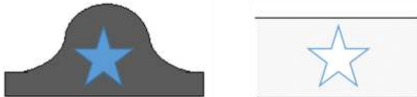
Figura 16 – Representação esquemática do princípio da microscopia eletrônica de transmissão por contraste negativo. A imagem é obtida pela região ocupada pela proteína na camada de acetato de uranila.
