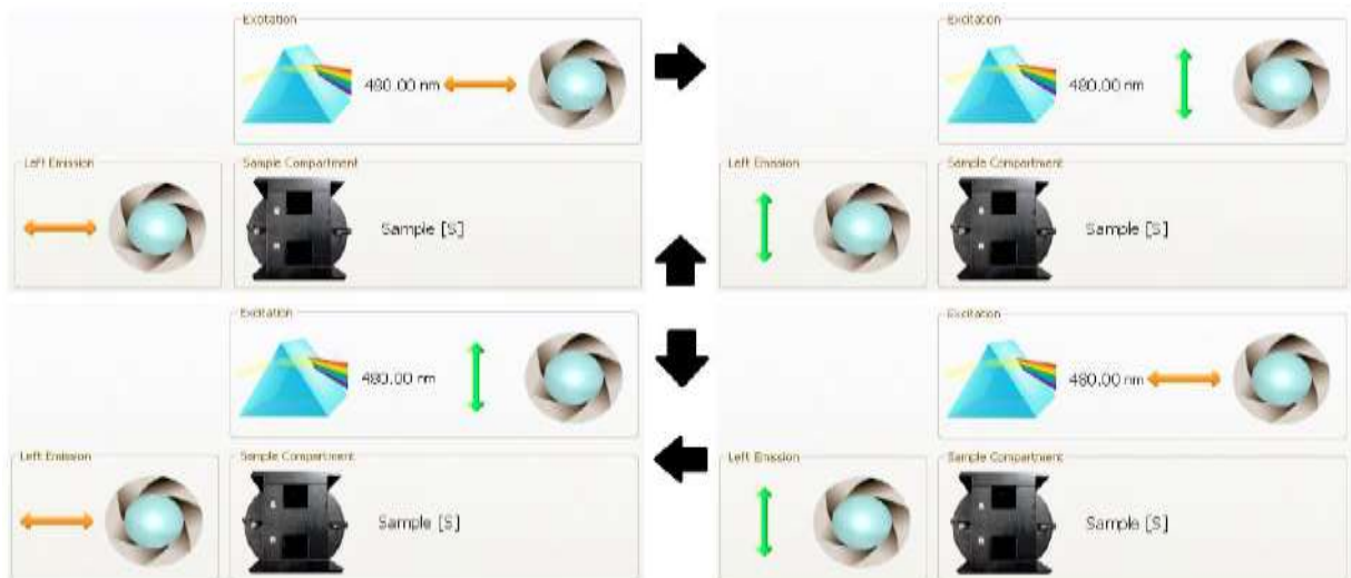
Figura 13 – Conjunto de configurações experimentais em que estão dispostos os polarizadores durante as medidas de anisotropia.
