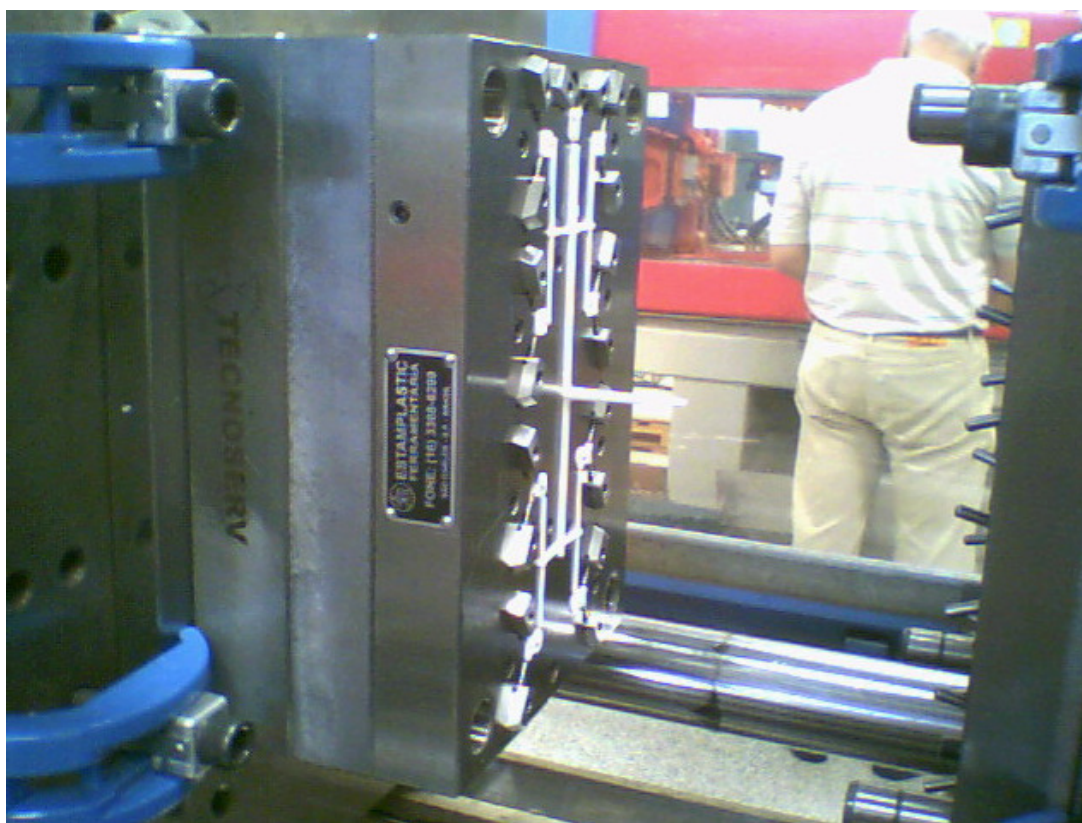
Figura 2.13 – Imagem mostrando o teste de injeção do molde dos grupamentos amins e carboxila
