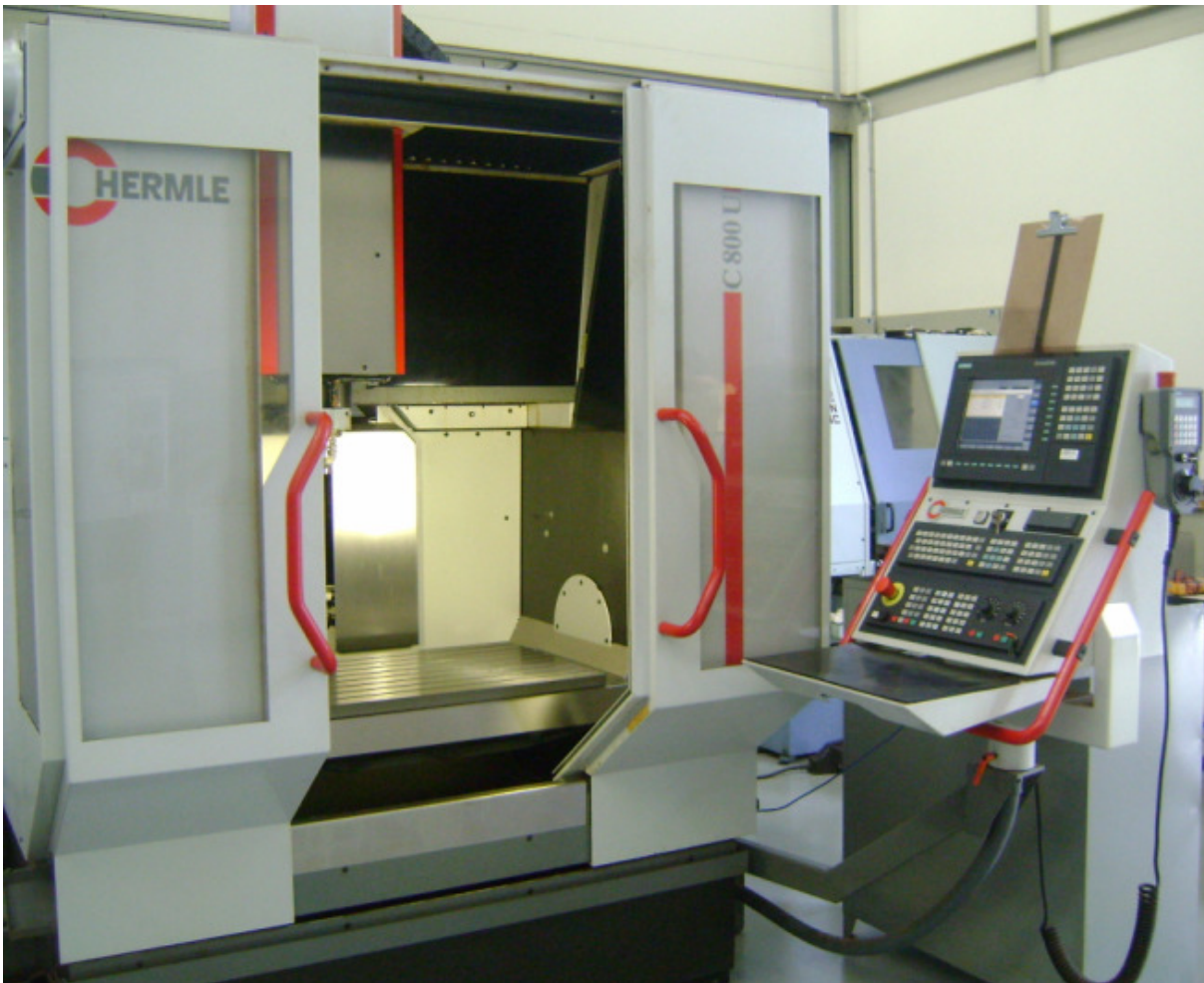
Figura 2.11 – Centro de usinagem do OPF utilizado para usinar as cavidades dos moldes
