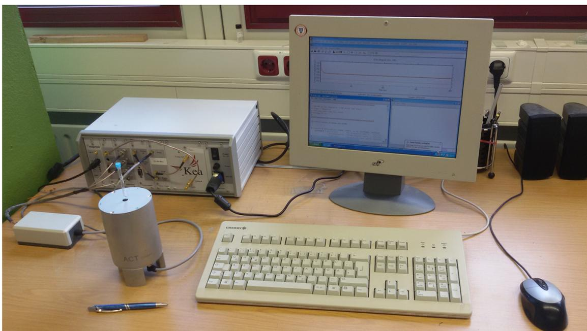
**Figura 4.11-** Montagem do espectrômetro KEA com o magneto mini-Halbach.
