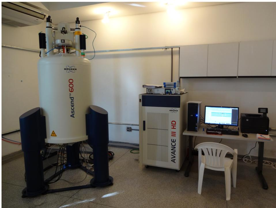
**Figura 3.1-** Espectrômetro Avance III da Bruker de 14,1 T com frequência de ressonância de 600 MHz para hidrogênio com sonda multinuclear de 5 mm de detecção inversa, localizado na *Embrapa Instrumentação*, São Carlos-SP.
