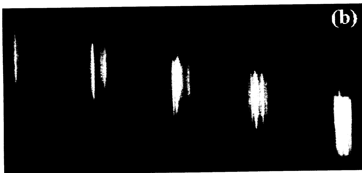
Figura 4.48. (a) Imagem de topografia de difração de raios X (modo de reflexão) para a reflexão (4 -4 4) de um cristal gradiente GdTaO_4-ErTaO_4 , obtida com radiação Cu K_\alpha e 45 min de tempo de exposição (b) Imagens ampliadas da região demarcada na figura (a) para diferentes posições angulares com 3 min de tempo de exposição cada.
