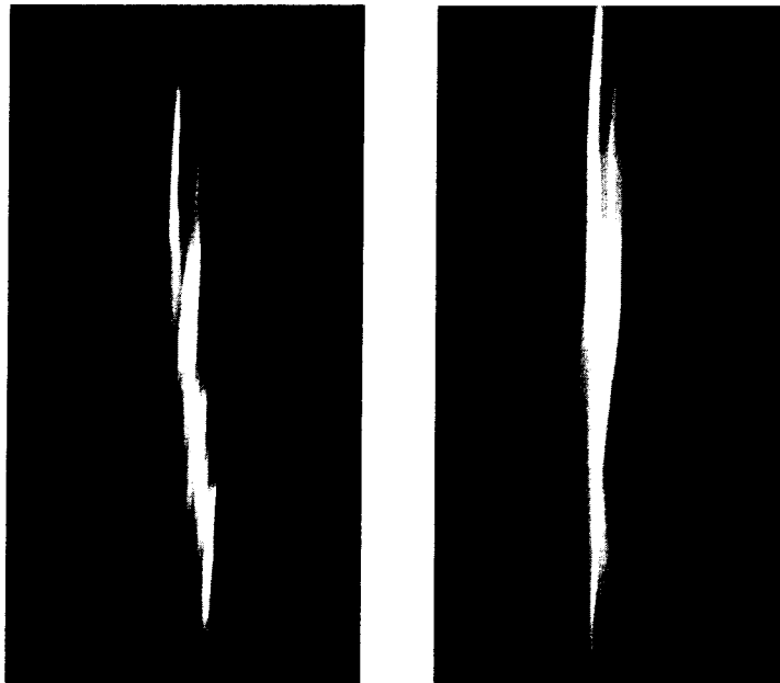
Figura 4.29. Topografias das reflexões (-2 -8 -4) à direita e (-4 4 -4) à esquerda, obtidas com radiação \text{Cu K}_{\alpha 1} e 60 min de tempo de exposição.
