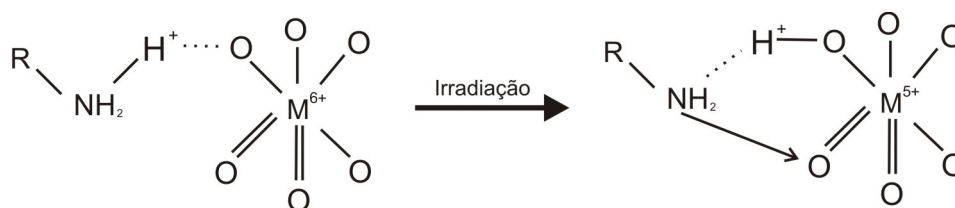
Figura 2.2 – Processo de formação do complexo de transferência de carga entre um POM e um grupo amina.
