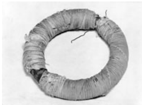
Figura 3.1. Bobinas utilizadas por Faraday na descoberta da indução eletromagnética.
