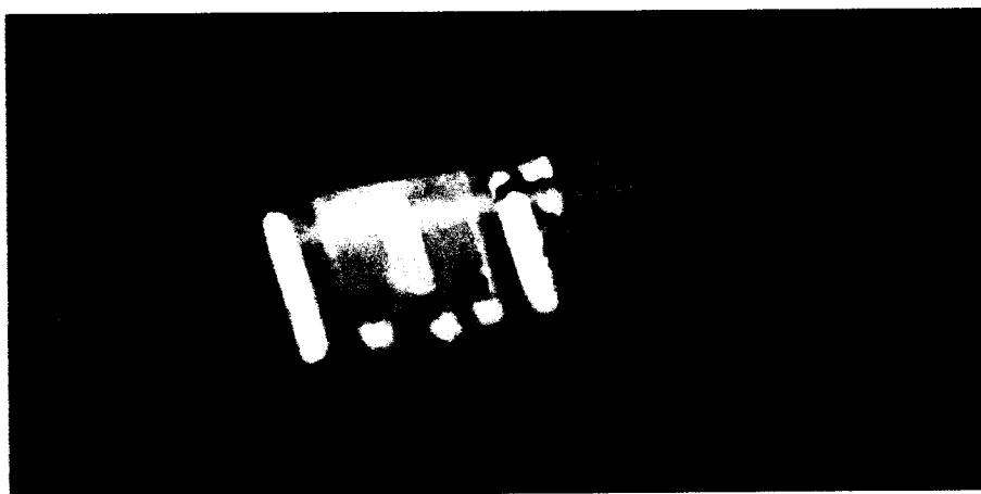
Figura 7.1 Dispositivo LB de OC 1 OC 6 -PPV (ITO/ OC 1 OC 6 -PPV/Al) encapsulado aceso com V = 8 V.
