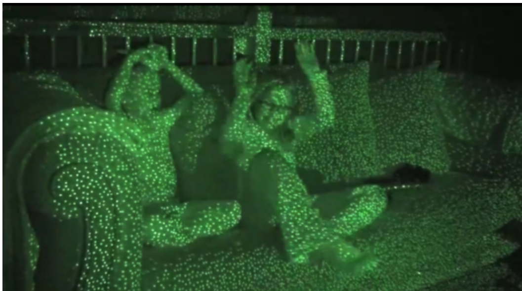
Figura 3.12 – Ambiente sob a luz estruturada do Kinect para XBOX Fonte: LIND, J. (147)
