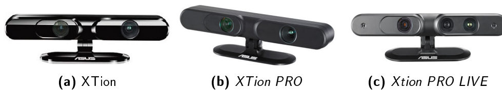
Figura 3.14 – Câmeras de luz estruturada da ASUS Fonte: ASUS MULTIMEDIA (155)
