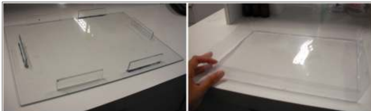
Figura 14 - Sistemas para coloração dos géis; bandeja de vidro à esquerda e folha de PVC à direita.
