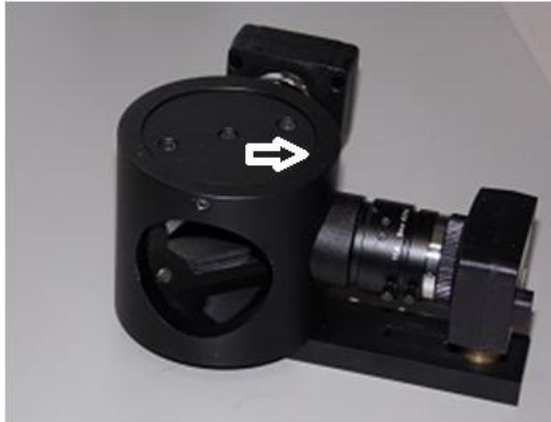
Figura 4 - Sistema de fixação das câmeras com espelho dicróico. A seta indica o cilindro de rotação que permite a rotação para calibragem do dicróico. Fonte: Elaborada pelo autor.
