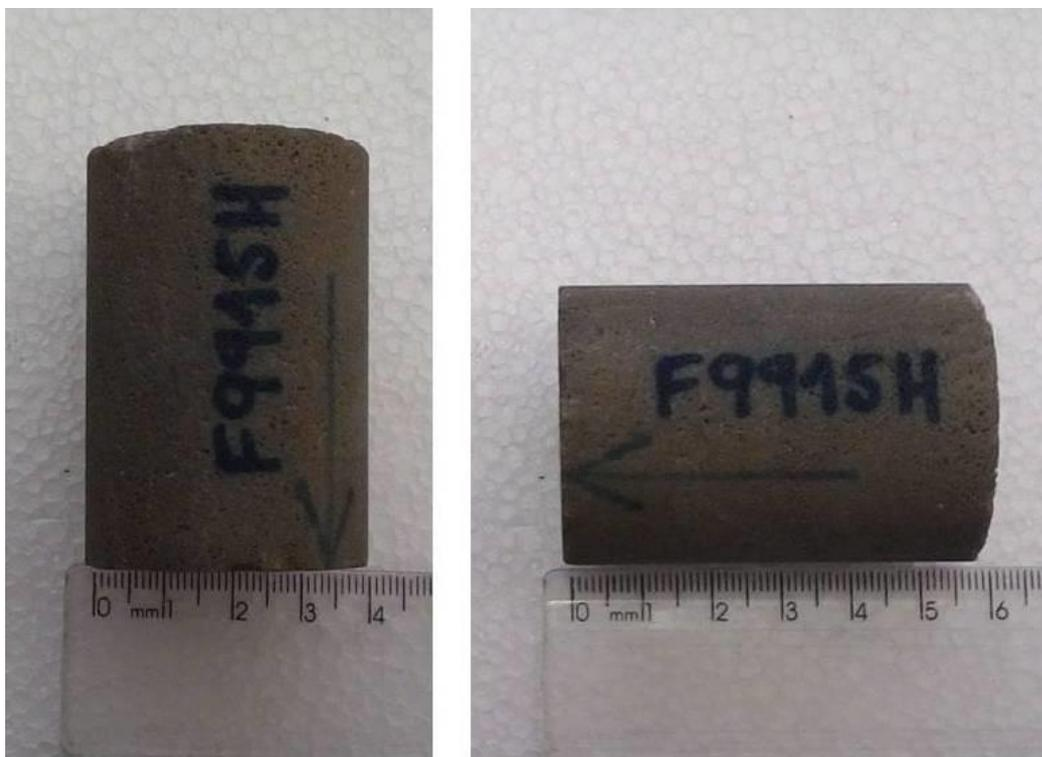
Figura 8 - Exemplo de rocha carbonática de reservatório (F9915H) de regiões profundas (pré-sal) utilizada no trabalho.
