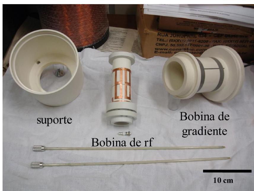
Figura 35 - Figura do sistema para obtenção de perfis unidimensionais, composto pelo suporte, a bobina de gradiente e a bobina de rf.
