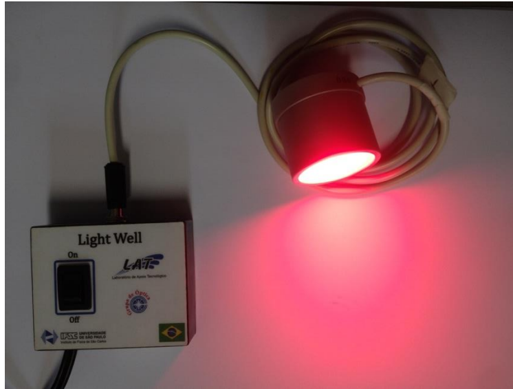
Figura 10 - Fonte de luz LED em 660 nm para iluminação de placa de Petri desenvolvido pelo Laboratório Apoio Técnico (LAT).
