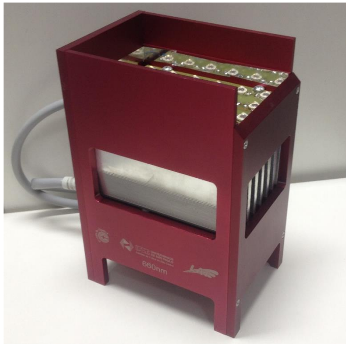
Figura 9 – Sistema de iluminação homogênea para placa de 96 poços Fonte: Elaborada pelo autor
