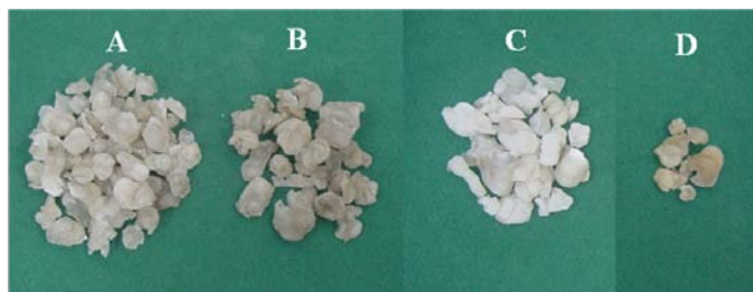
Figura 5.1- Aspecto dos quatro tipos de amostras de gel extraídas da barragem de Furnas (Minas Gerais). (A) Branca transparente. (B) Amarelo claro. (C) Branco. (D) Marrom.
