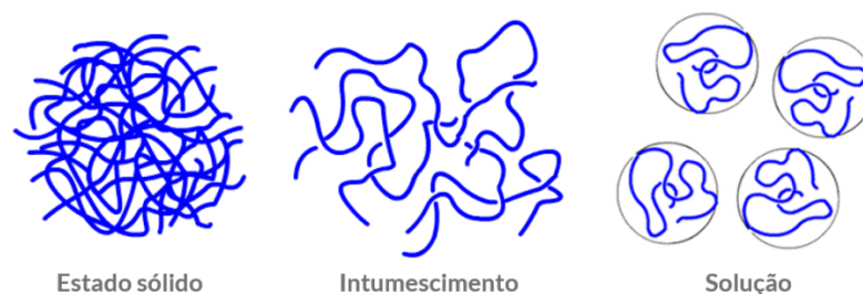
Figura 12. Representação esquemática do arranjo das cadeias poliméricas em diferentes estágios da dissolução.
