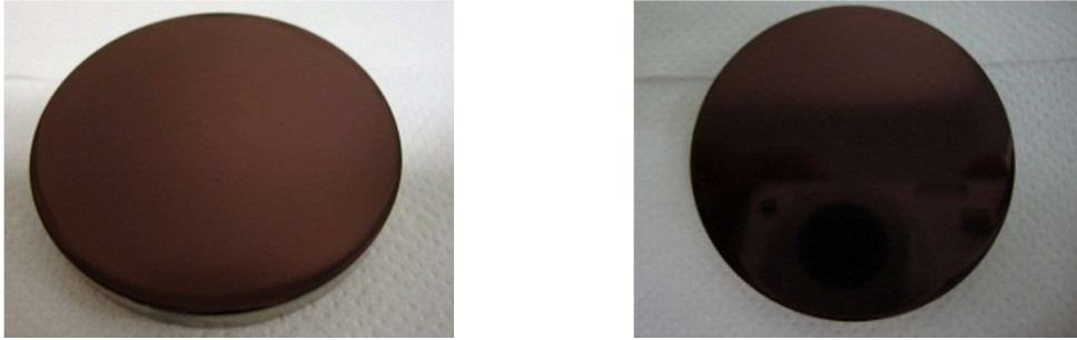
Figura 37 - Aço 316 com solda de 100 A recoberto com PANi.
