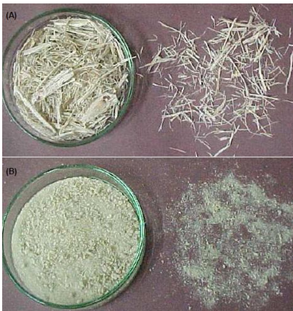
Figura 02 – Características visuais das frações do bagaço de cana-de-açúcar. a) Fração fibra; b) Fração medula.
