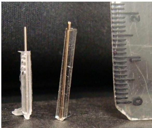
**Figura 10.** Comparação entre as barras de PDMS produzidas pelo molde antigo (à esquerda) e pelo molde novo (à direita).
