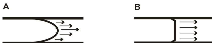
Figura 5. Perfil de fluxo típico da técnica de HPLC gerado por pressão (A), e perfil de fluxo típico da técnica de CE gerado por EOF (B).
