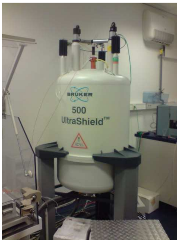
Figura 2.4. Equipamento de ressonância magnética nuclear.
