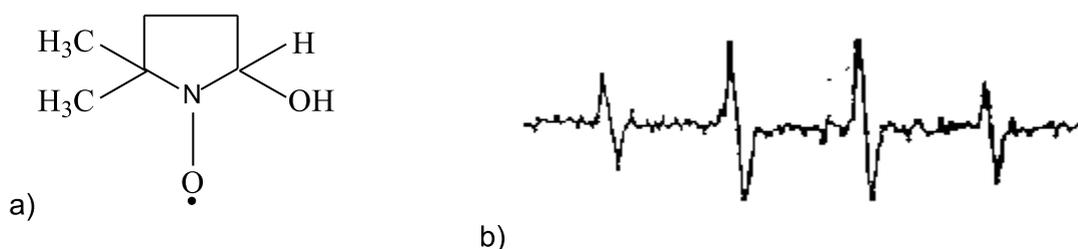
**Figura 8** – a) Fórmula estrutural do 5,5-dimetil-1-pirrolina-N-óxido e b) espectro do aduto DMPO/OH com constante de acoplamento hiperfino de  $a_N = a_H = 14,9 \text{ G}$  <sup>111</sup>.
