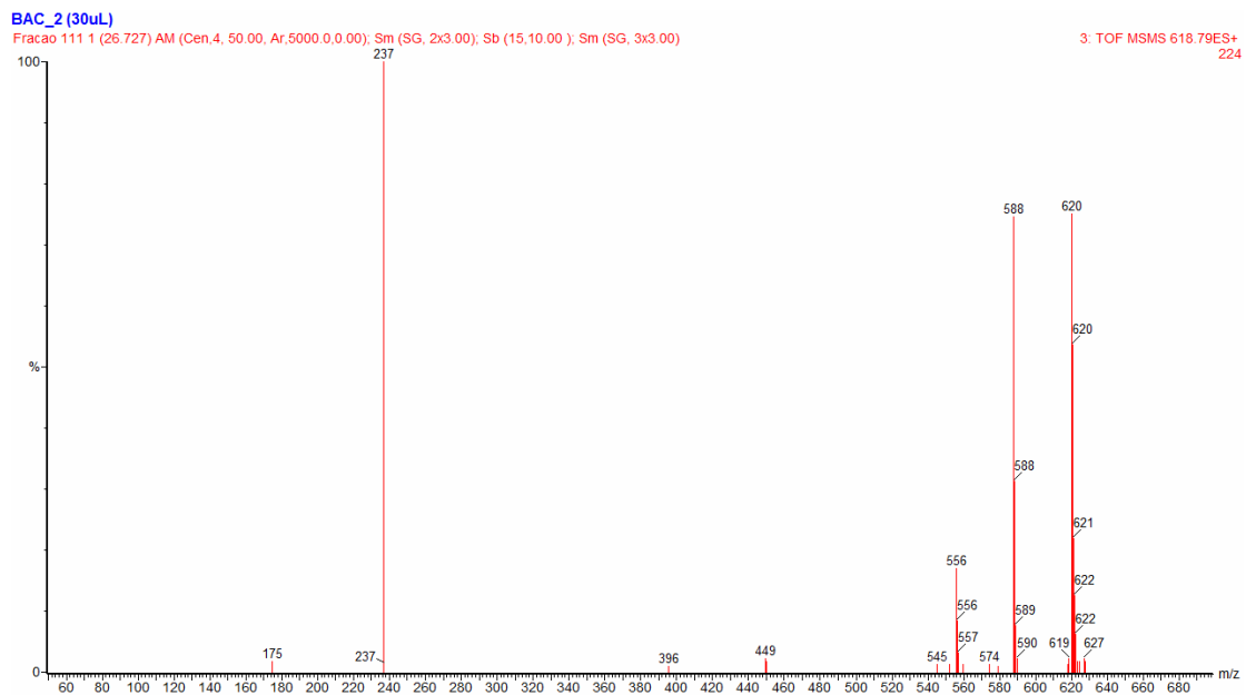
Figura 4.4 Espectro de MS/MS obtido automaticamente por ESI-QToF, referente à fração n o 111 ( m/z 618) da amostra de bacterióide.
