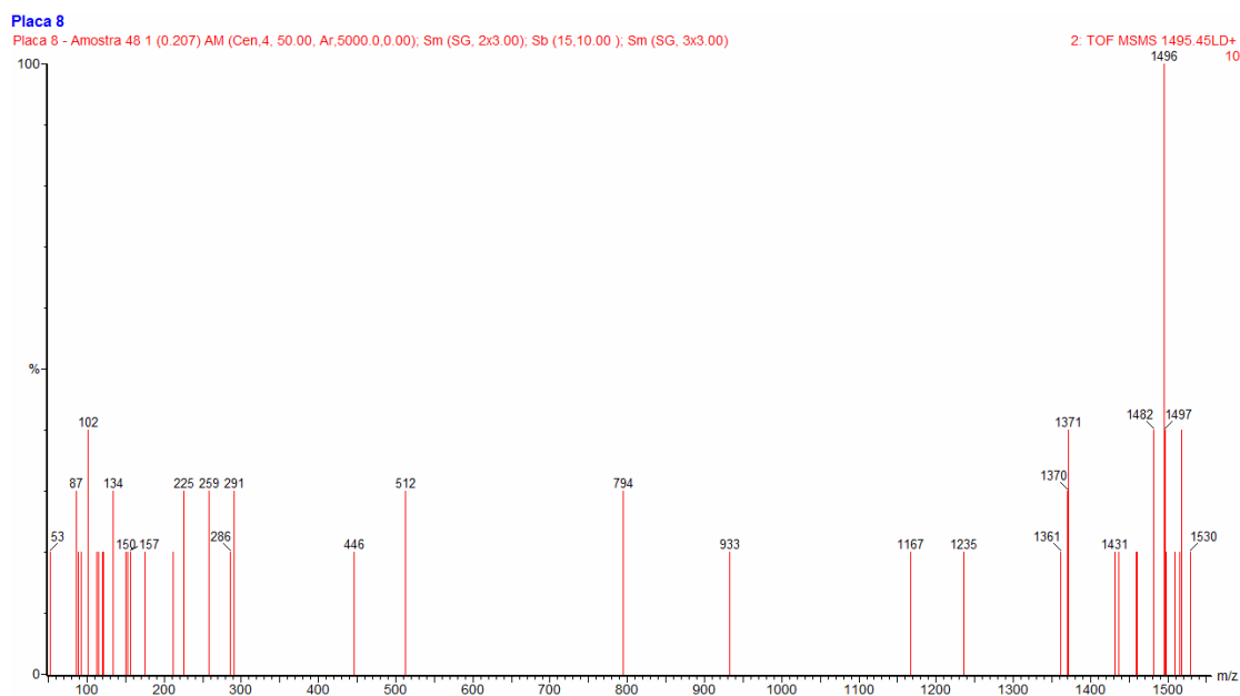
Figura 3.3. Espectro de MS/MS obtido automaticamente por MALDI-QToF referente ao spot nº 760 ( m/z 1495) da amostra de bactéria.
