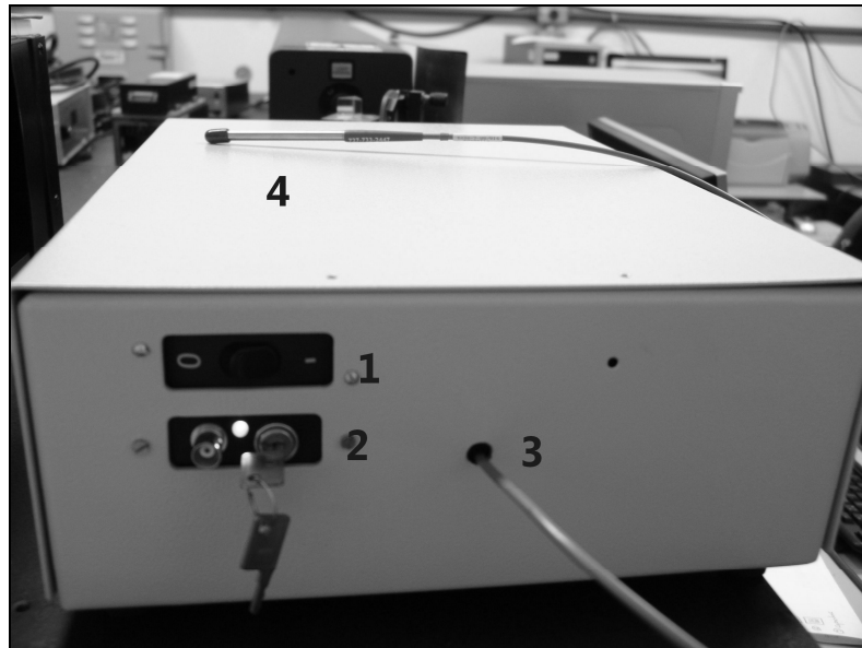
Figura 2.9 - Sistema de FIL portátil com excitação em 405 nm ( direita ): 1 – chave de energia laser; 2 – caixa de controle laser; 3 – saída para o cabo óptico; 4 – ponta emissora/coletora do cabo óptico.
