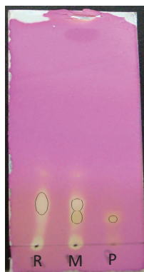
Figura 9. Evolução dos precursores – isohumulonas - e produtos da reação – tetrahidro-isohumulonas - no sistema de cromatografia planar utilizando sílica gel como fase estacionária e hexano/éter etílico (1:1 v/v) acidificado com ácido acético como fase móvel. (R) reação; (M) mistura; (P) precursores.
