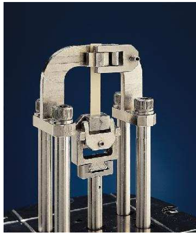
Figura 13 – Garra utilizada para análise das membranas derivadas de pericárdio porcino no equipamento de DMTA.
