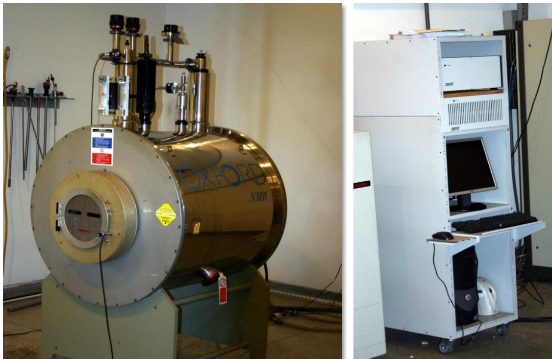
Figura 26. Magneto do Tomógrafo/espectrômetro de 2,1 T e CAT-100 da Tecmag.
