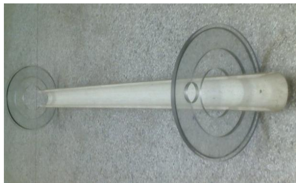
Figura 32. Visão interna da bobina, esteira e guia montado. b) Guia de PVC suportado por duas placas de acrílico nas dimensões do tomógrafo.
