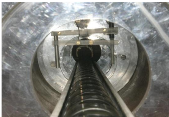
Figura 32. Visão interna da bobina, esteira e guia montado. b) Guia de PVC suportado por duas placas de acrílico nas dimensões do tomógrafo.
