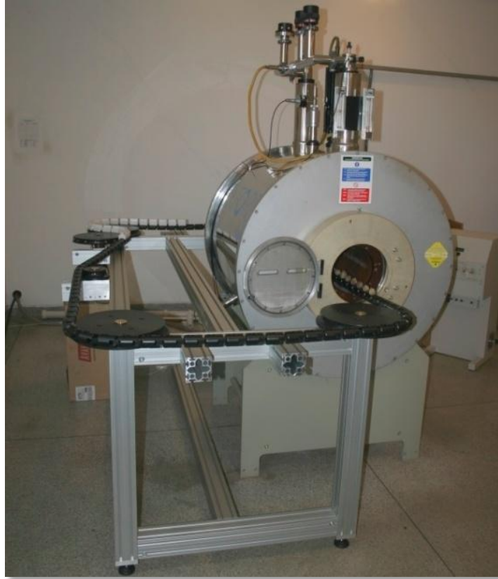
Figura 30. Esteira mecânica de poliacetal, formada por 105 gomos de 65 mm atravessando o bore de 30 cm de diâmetro do magneto de 2,1 T.
