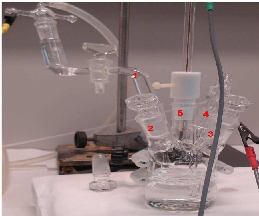
**Figura 3-7** Célula eletroquímica: 1 – eletrodo reversível de hidrogênio, 2 – entrada de reagentes, 3 – contra-eletrodo, 4 – borbulhador, 5 – eletrodo de trabalho.
