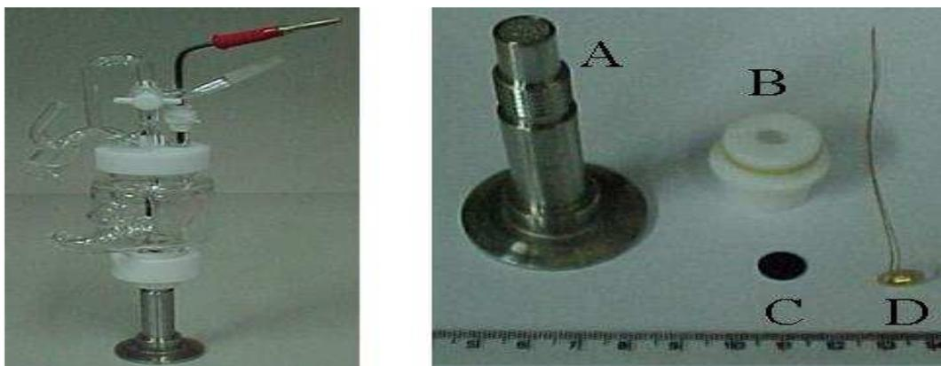
**Figura 3-8:** Célula eletroquímica de DEMS. No detalhe são mostrados o suporte metálico (A), a base da célula com o o-ring para vedação de solução(B), eletrodo de trabalho (C) e o disco de Au para contato elétrico do eletrodo de trabalho (D).
