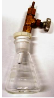
Figura 15: Erlenmeyer utilizado como reator para síntese de poliuretanos, ao qual foi acoplado uma válvula para obtenção de atmosfera inerte.
