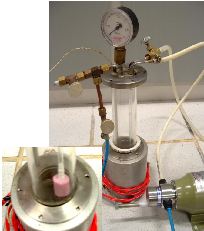
Figura 12: Reator com borbulhamento promovido por uma bomba de ar acoplada a uma haste de vidro com uma pedra porosa na ponta (destacada).
