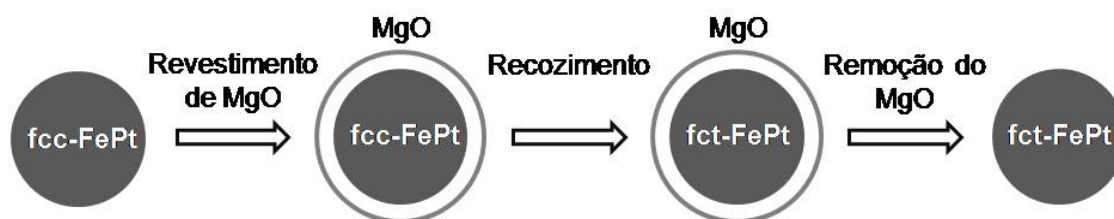
Figura 8. Processo de proteção de nanopartículas de FePt durante o processo de recozimento através de recobrimento com MgO [33].
