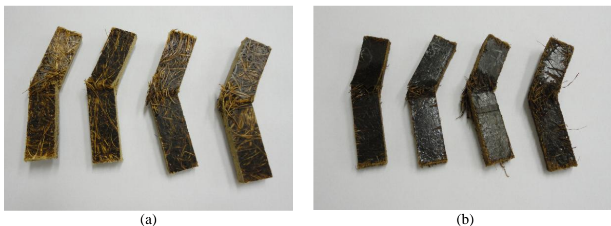
Figura 74: Corpos-de-prova após o ensaio de Impacto Izod: (a) glutaraldeído-lignossulfonato de sódio/sisal ( CGLS ); (b) glutaraldeído-lignina organossolve/sisal ( CGLOS ).
