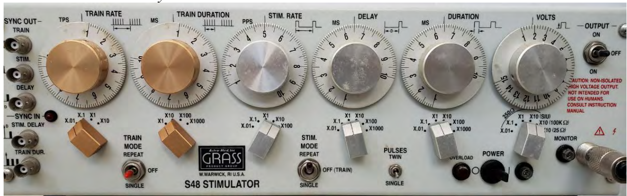
Figura 4.3- Neuroestimulador S48 GRASS usado para estabelecer o estímulo supramáximo em Chelonia mydas .
