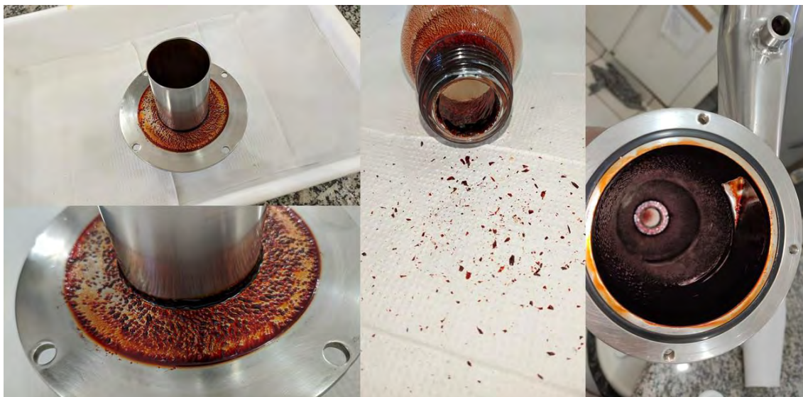
Figura 6 - Secagem do extrato de própolis vermelha sem coadjuvante de processo por spray drying
