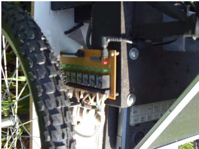
Figura 48 - placa de acionamento dos motores instalada no protótipo
