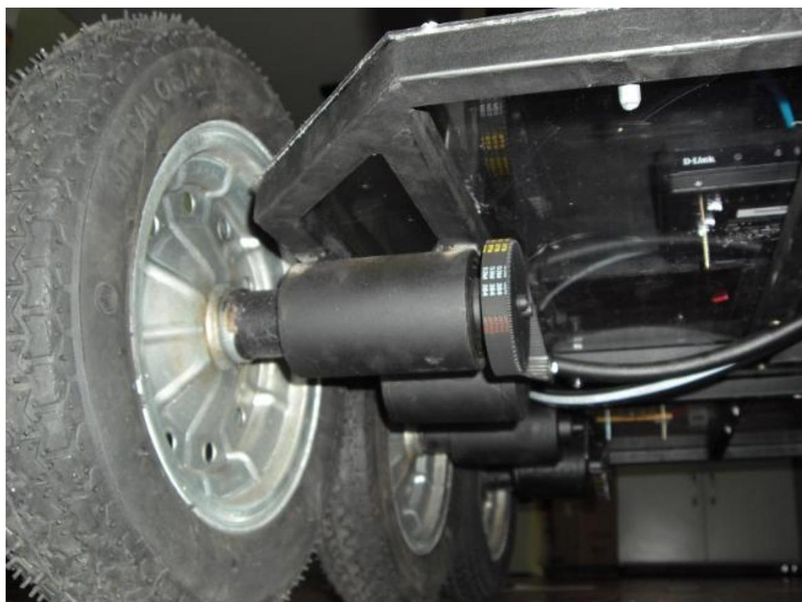
Figura 62 – Foto das rodas, eixo e motores.
