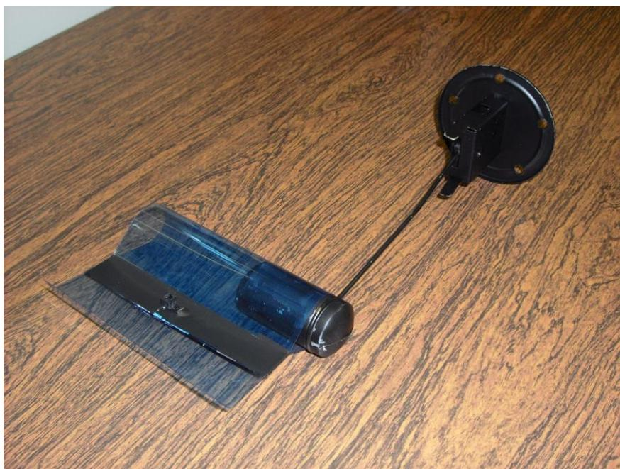
Figura 56 – Sensor construído para medição da altura da forragem
