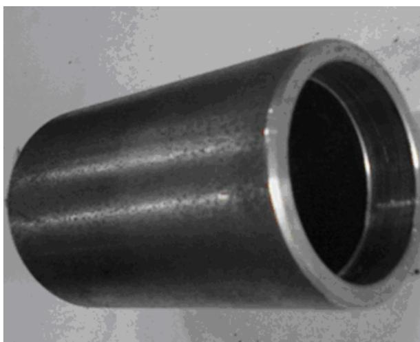
Figura 28 – Foto do cilindro base do eixo usinado em aço 1020.
