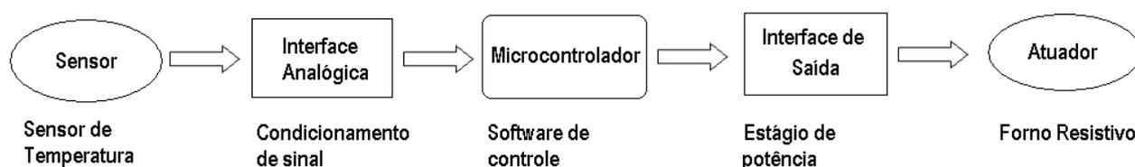
Figura 5 - Diagrama de blocos de um sistema de controle.
