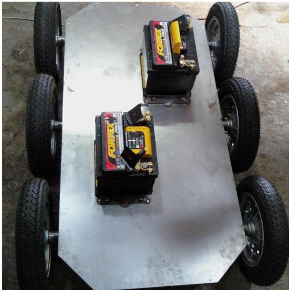
Figura 54 – Foto da base e disposição das baterias utilizadas para alimentação do robô autômato.
