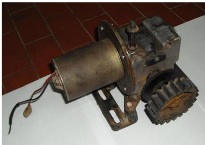
Figura 51 – eixo e motor criado para o terceiro protótipo.
