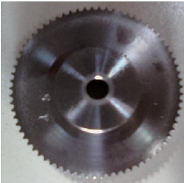
Figura 30 – Foto da polia que foi acoplada ao eixo.
