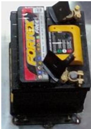
Figura 34 – Bateria utilizada para alimentação do terceiro protótipo. 12volts 40 amperes.
