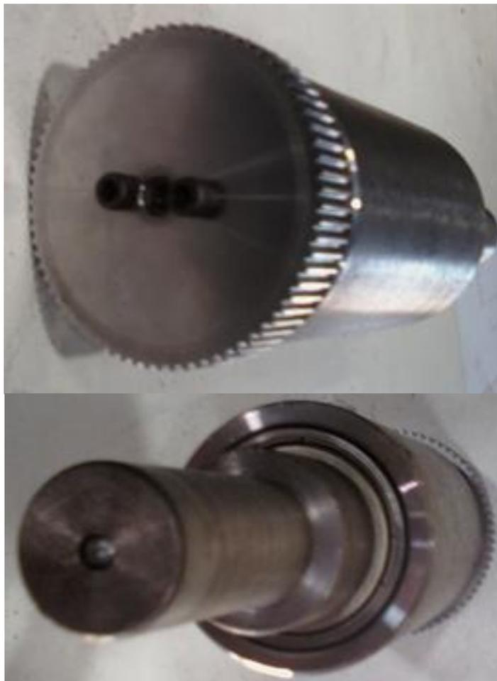
Figura 53 – Fotos do eixo montado.
