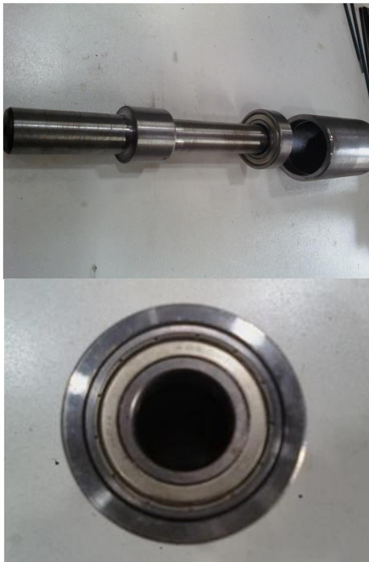
Figura 52 - Peças do eixo do terceiro protótipo.
