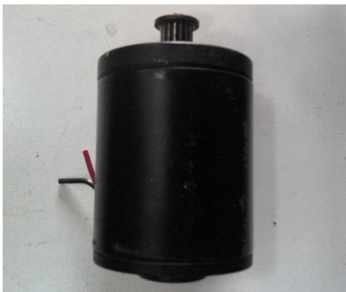
Figura 26 – Motor de corrente contínua, 24 Volts 100watts, utilizado no terceiro protótipo.
