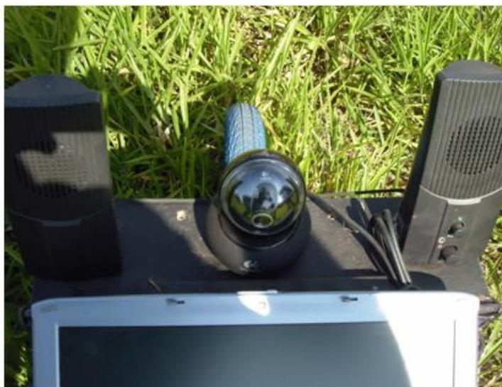
Figura 46 – Sistema de captura de imagem do segundo protótipo.
