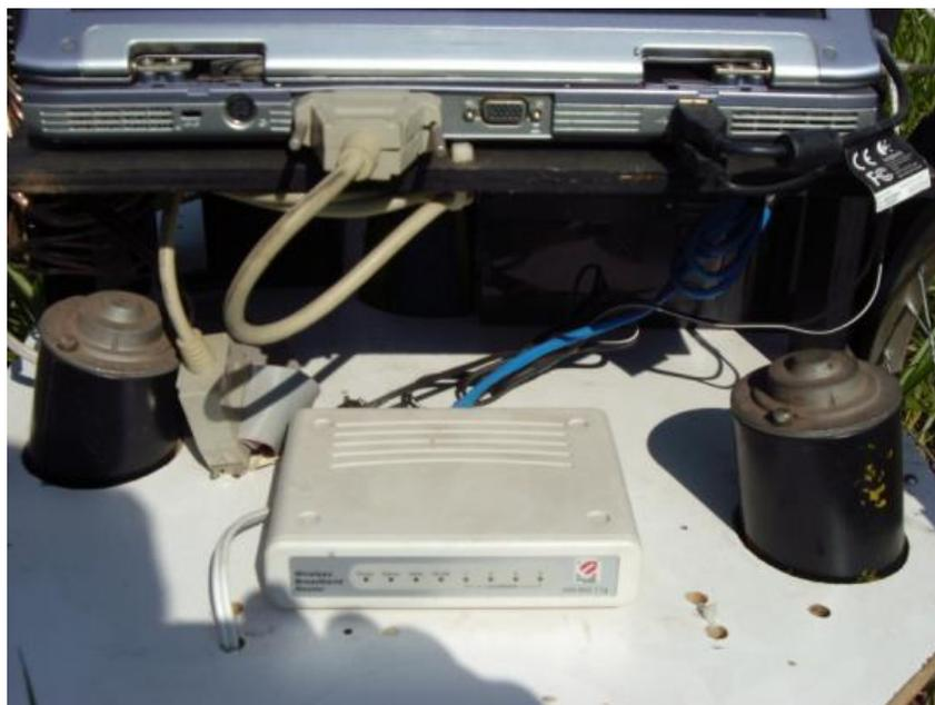
Figura 22 – Foto do segundo protótipo, roteador “wireless” utilizado para a conexão do robô e computador central.
