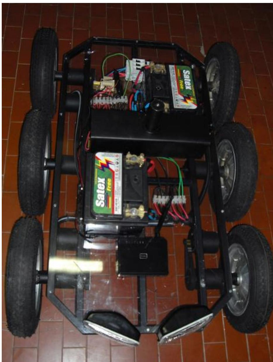
Figura 60 – Disposição dos equipamentos elétricos e eletrônicos no terceiro protótipo, vista de frente.
