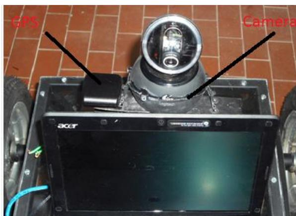
Figura 58 – Câmera motorizada e GPS instalados no terceiro protótipo.
