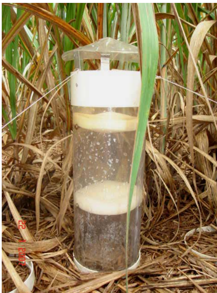
Figura 9. Coletor de amônia instalado no campo.
