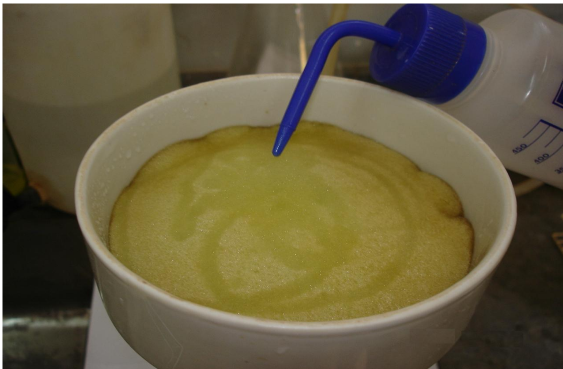
Figura 15. Lavagem da espuma sobre o funil de porcelana para a retirada da amônia.
