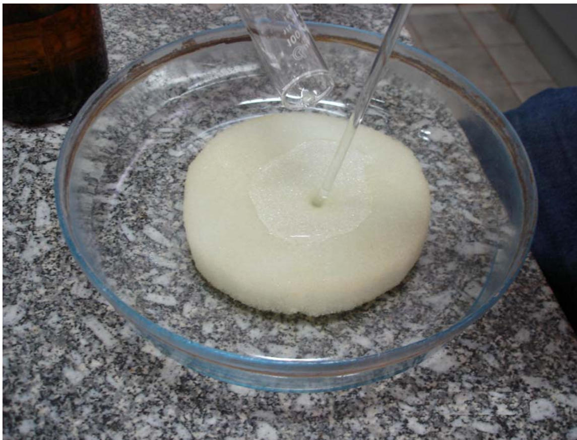
Figura 11. Embebecimento das espumas do coletor semi-aberto com ácido fosfórico.
