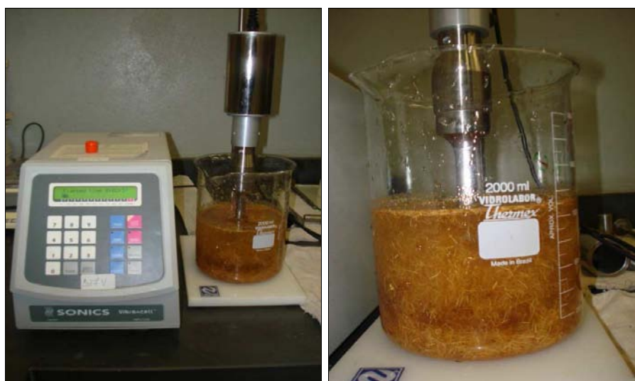
Figura 5. Imagem do equipamento e das fibras passando pelo tratamento por ultrassom.
