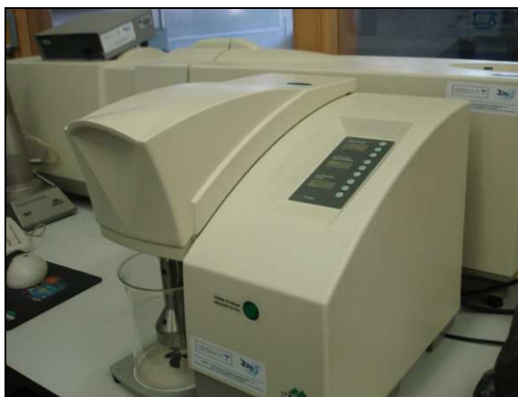
Figura 16. Equipamento Hydro 2000MU ® utilizado na determinação granulométrica da cinza de casca de arroz.
