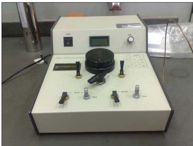
Figura 9. Multiplicnômetro para determinação da densidade real das fibras.
