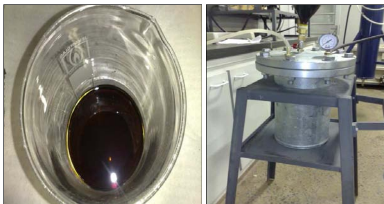
Figura 7. Detalhe da solução de álcool furfurílico com ácido paratolueno sulfônico e vista geral do equipamento utilizado na impregnação das fibras.
