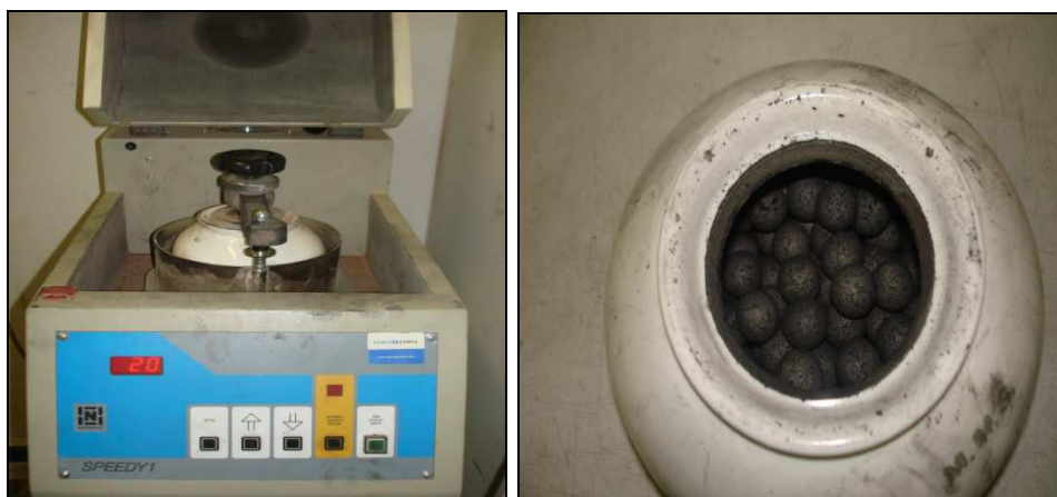
Figura 15. Vista do moinho de jarro e detalhe das esferas utilizadas durante o processo de moagem da cinza da casca de arroz.
