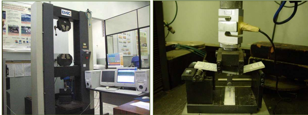
Figura 20. Visão geral da máquina universal de ensaios mecânicos EMIC® e ensaio de flexão a quatro pontos de um corpo-de-prova.
