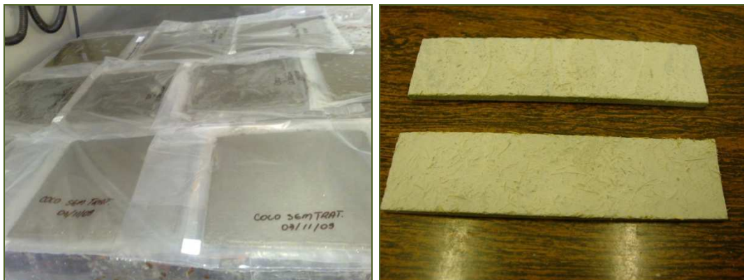
Figura 19. Placas reforçadas com fibras de coco verde durante o processo de cura (primeiros dois dias) e corpos-de-prova resultantes.
