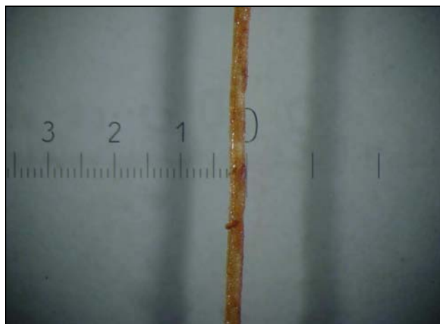
Figura 8. Medida da espessura da fibra de coco verde no estéreo-microscópio.
