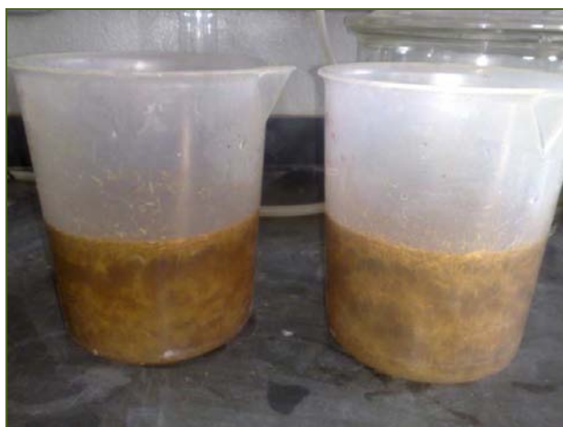
Figura 6. Vista das fibras de coco verde imersas nas soluções de silicato de sódio (béquer esquerdo) e sulfato de alumínio (béquer direito).
