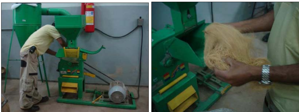
Figura 4. Processo de picagem das fibras de coco verde em moinho de facas com peneira selecionadora.
