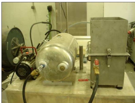
Figura 17. Sistema desenvolvido para moldagem de placas pelo processo de drenagem e prensagem.
