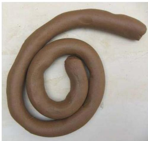
Foto 24: Torção do rolete feito com a segunda amostra de argila, sem adição de antiplástico.
