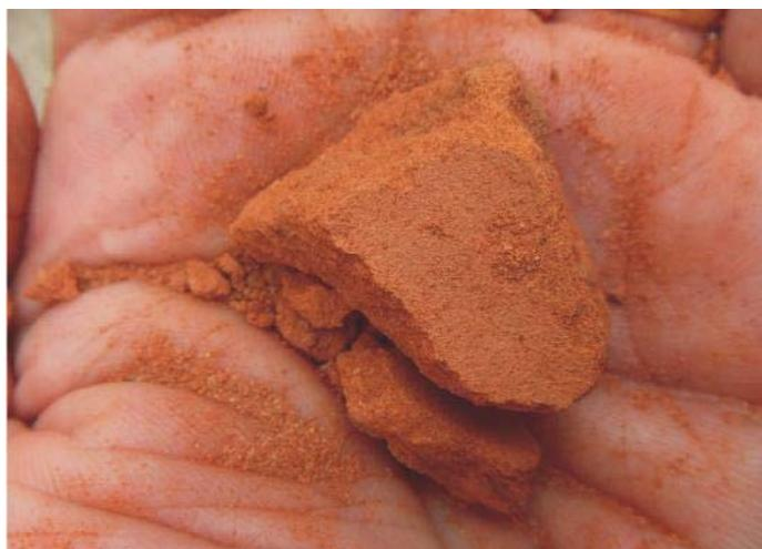
Foto 42: Fragmento de cerâmica confeccionada com argila do tipo “terracota” tratada com a adição de antiplástico mineral (areia fina) após a queima. Nota-se que a “cerâmica” ficou com um aspecto bem parecido aos tijolos de construção.
