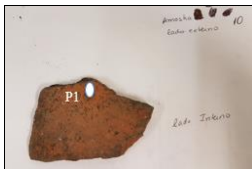
Figura 60. Pontos medidos por FXR na superfície externa, em que no P1 há a presença de pigmento.
