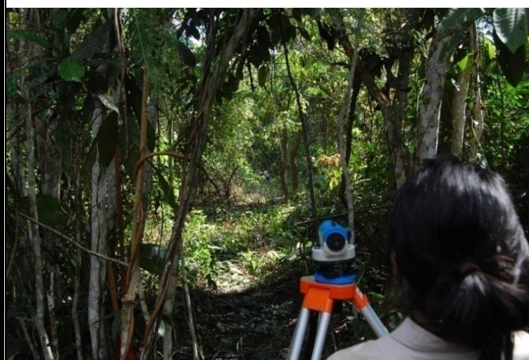
Figura 43: Alocação dos pontos de tradagens com auxílio de nível ótico (G.M.)
