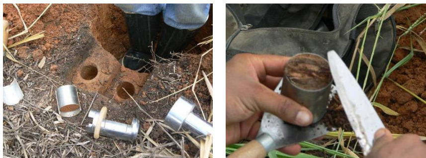
Figura 2.7 – Amostragem de solo com cilindros para obtenção da densidade
