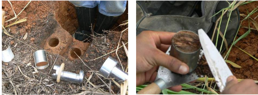
Figura 6.2 – Amostragem de solo para obtenção da densidade
