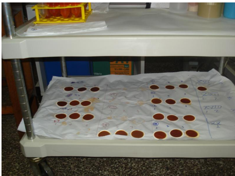
Figura 21 - Filtro de membrana GS em ester de celulose 0,22 \mu m de poro de 47mm de diâmetro coletado a partir de filtração de amostra de água tratada com o PAR e triton 5% (v/v)
