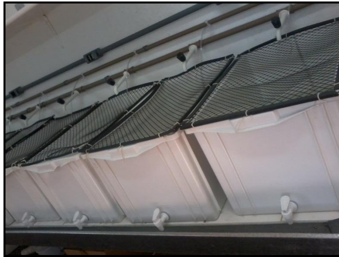
Figura 3 – Cubas plásticas com telas na superfície, utilizadas nos ensaios preliminares e agudos de cobre, cádmio, cobre+cádmio e ensaios de injeção intraperitoneal (UNESP-Rio Claro)
