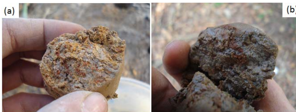
Figura 2.27 – Evidências morfológicas de porções acinzentadas da matriz do solo bem como mosqueados nas cotas intermediárias das zonas de convergência 1 e 3. O mesmo foi encontrado na zona de convergência 2
