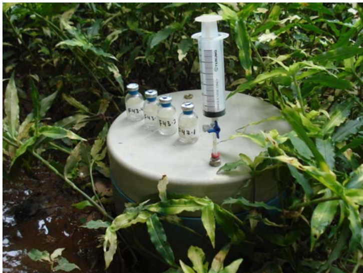
Figura 3.15 - Câmara estática fechada utilizada para a obtenção de amostras de ar oriundo do solo
