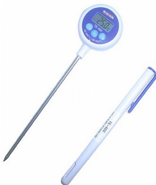
Figura 3.16 - Termômetro utilizado para medir a temperatura do solo
