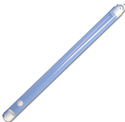
Figura 3.14 - Bailer: amostrador de água subterrânea
