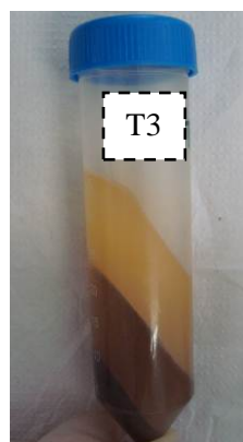
Figura 3.2 - Frações do hidrolisado proteico de resíduo de tilápia após centrifugação T3: Enzima neutrase (E1) x 4 horas de hidrólise
