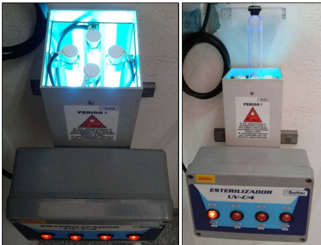
Figura 12 - Detalhes do reator UV-C. A – caixa de aço-inoxidável que envolve o reator, sem tampa, com módulo eletrônico e, B – Conjunto demonstrativo do reator com tampa aberta
