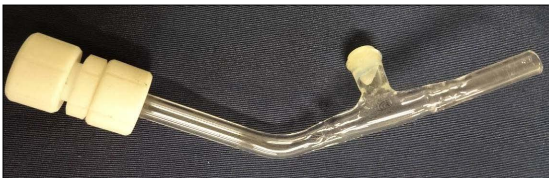
Figura 6 – Peça que acopla o Sistema 1 ao Reator UV-C, com o detalhe do ponto de amostragem e dosagem de reagentes, com rolha de silicone adaptada
