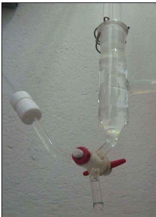
Figura 4 – Peça de encaixe na base da coluna de reação do sistema S1
