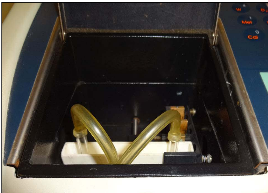
Figura 42 - Ilustração do dispositivo para passagem e leitura do gás O_3 , devidamente encaixado no carrinho do espectrofotômetro.
