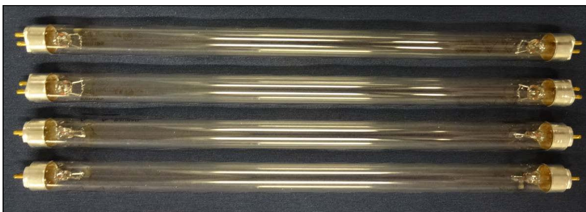
Figura 9 - Lâmpadas UV-C com emissão em 254 nm utilizadas no Reator UV-C
