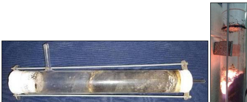
Figura 8 – Destruidor de ozônio residual fabricado em quartzo para resistir ao calor do carvão em brasa
