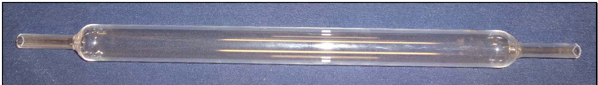
Figura 11 - Tubo de Quartzo de alta pureza construído para uso no interior do Reator UV-C
