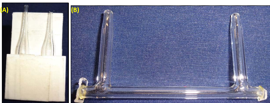
Figura 22 – (A) Tubo em vidro neutro inserido no suporte e (B) Tubo em vidro neutro e quartzo de alta pureza, com adaptações para passagem do gás
