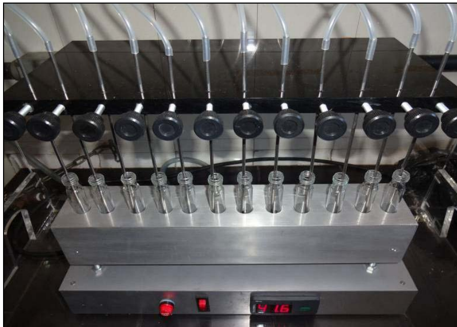
Figura 17 – Equipamento para secagem das amostras pós SPE, utilizando nitrogênio como gás de arraste
