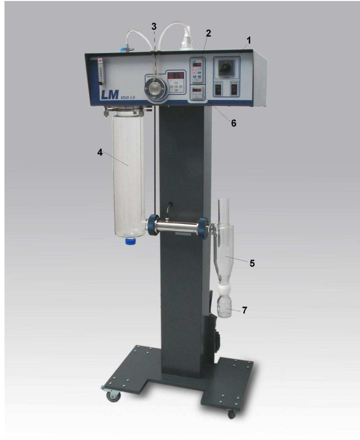
Figura 4. Spray dryer de escala laboratorial modelo LM MSD 0.5 (Labmaq do Brasil Ltda., Brasil): 1) chave geral 2) controle do aquecimento; 3) controle de bombeamento de líquido; 4) câmara de secagem; 5) separador de pó; 6) indicador de temperatura de saída; 7) frasco coletor (LABMAQ, 2003).
