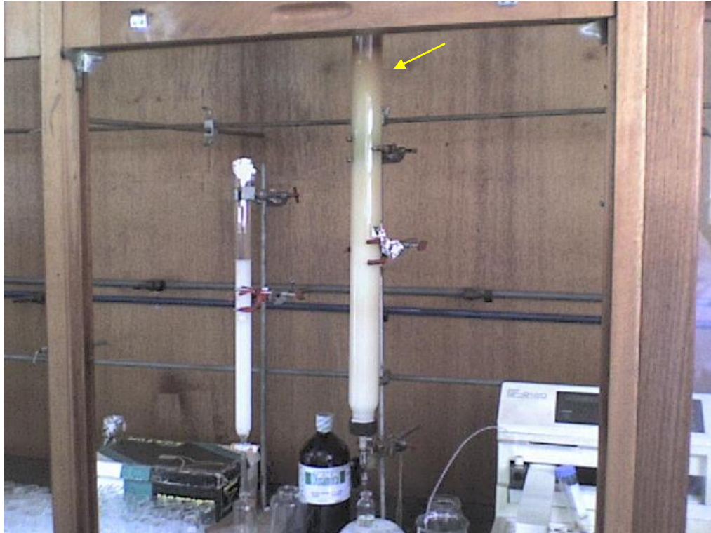
Figura 9: Coluna com Sephadex ® LH 20 durante a realização do fracionamento da amostra.
