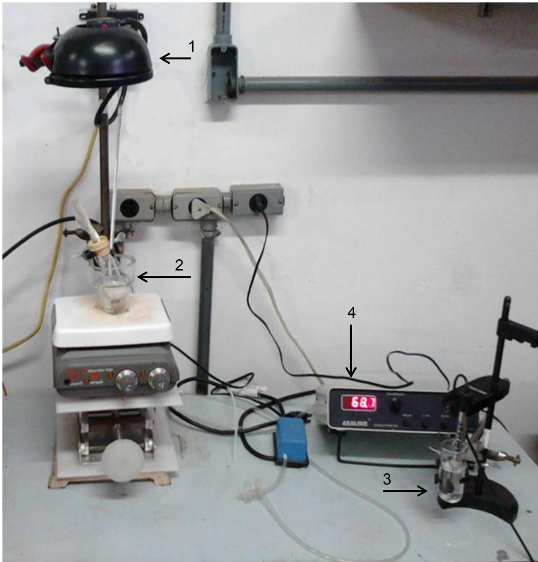
Figura 17. Sistema para simular o Rancimat, sendo: (1) lâmpada de xenônio; (2) óleo de rícino com ou sem amostra; (3) água; (4) condutivímetro.
