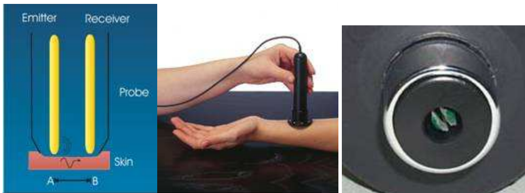
Figura 5. Sonda para determinação das propriedades mecânicas da pele por vibração ( Reviscometer ®).
